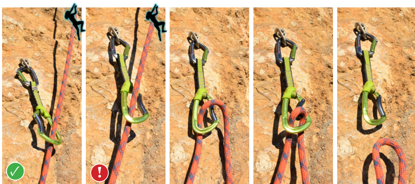
Komplet je vpet pravilno, a spodnja vponka gleda v smer plezanja in se lahko ob padcu izpne.
