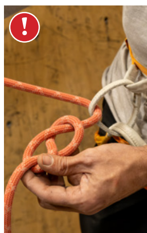
Osmico vpleteno samo skozi pasno in povezavo nožnih zank. Ostali načini niso primerni.
